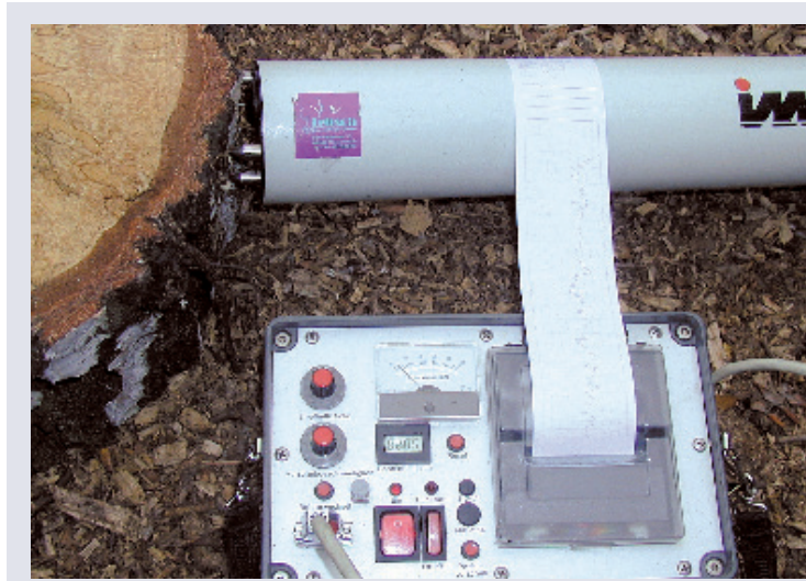
Beim Resistographen wird mit einer feinen Bohrnadel mit 1,5 mm Durchmesser der Bohrwiderstand und damit die jeweilige Dichte des Holzes gemessen und grafisch aufgezeichnet.
