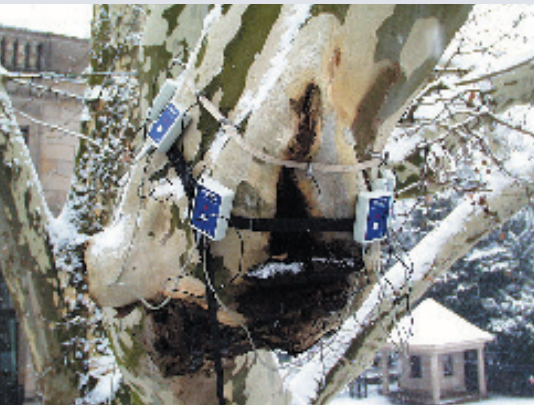
Auch eingehende Untersuchungen der Holzzerstörung pilzinfiltrierter Bäume mit dem Picus-Schalltomographen gehört zum Leistungsspektrum.
